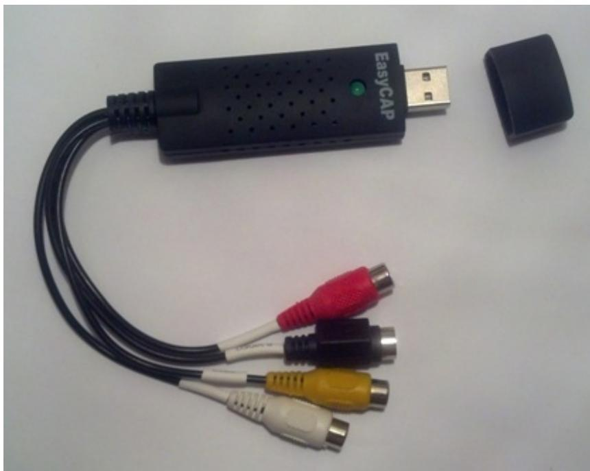
Сам гаджет выполнен в виде большой флешки. USB-разъем заботливо закрыт колпачком. Порадовало качество исполнения корпуса — во-первых, он прорезинен, то есть используется технология Soft-Touch; во-вторых, предусмотрительно сделаны отверстия вентиляции по всему периметру корпуса (EasyCAP при работе немного нагревается). Гаджет оснащён выведенными разъемами для подключения RCA-кабелей (тюльпанчики) и разъемом для подключения S-Video. Каждый провод подписан небольшой меткой.
